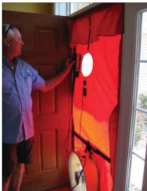
Blower door test
