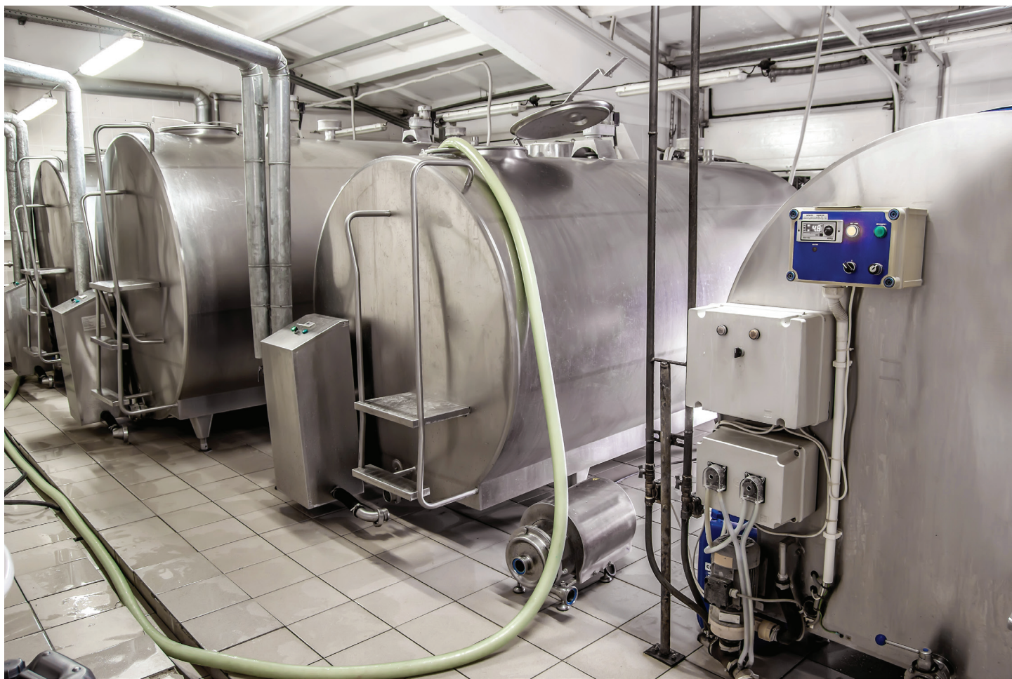
Tanque de leche a granel con sistema de refrigeración integrado.
